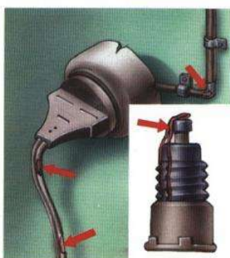
Неисправность электропроводки Пользование самодельными предохранителями
